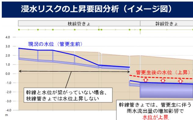
これらを小流域ごとに整理し、「管更生を実施しても浸水リスクが上昇しない地区」と「管更生を実施すると浸水リスクが上昇する地区」に分類し、**段階的な対策方針**を定めます。
